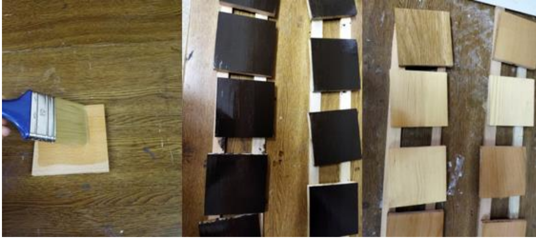
Resim 2.3. Deney örneklerinin verniklenmesi
