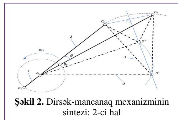
Şəkil 2. Dirsək-mancanaq mehanizminin sintezi: 2-ci hal
