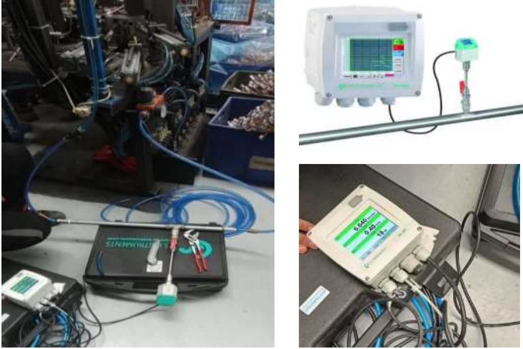
Şekil 7 CS Instruments DS400 Debi Ölçer aletinin ölçüm sırasındaki görselleri
