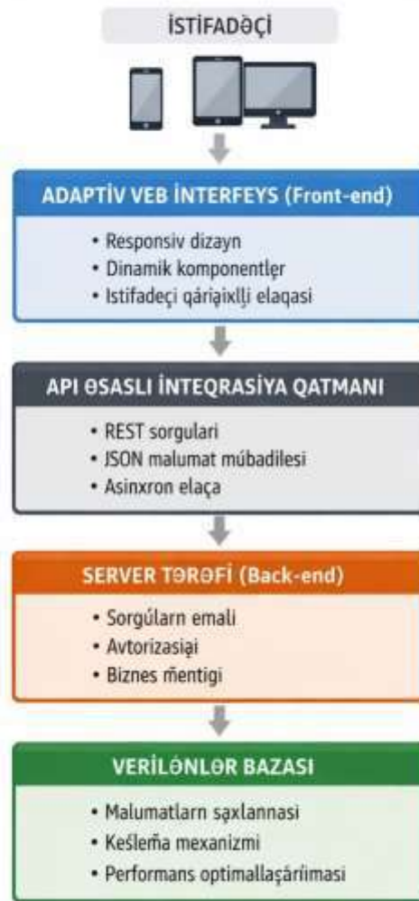
Sxem 1. Adaptiv Veb İnterfeysdə Front-end və Back-end İnteqrasiya Modeli
